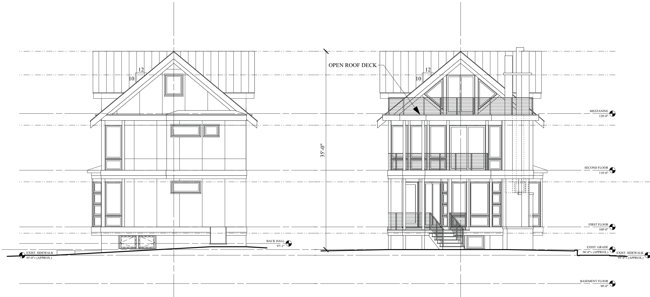
2 WEST ELEVATION A-2.1 Scale: 1/8" = 1'-0"
